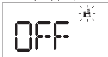
Obr.111 Vypnutie prevádzky v režime teplej úžitkovej vody (TÚV)
